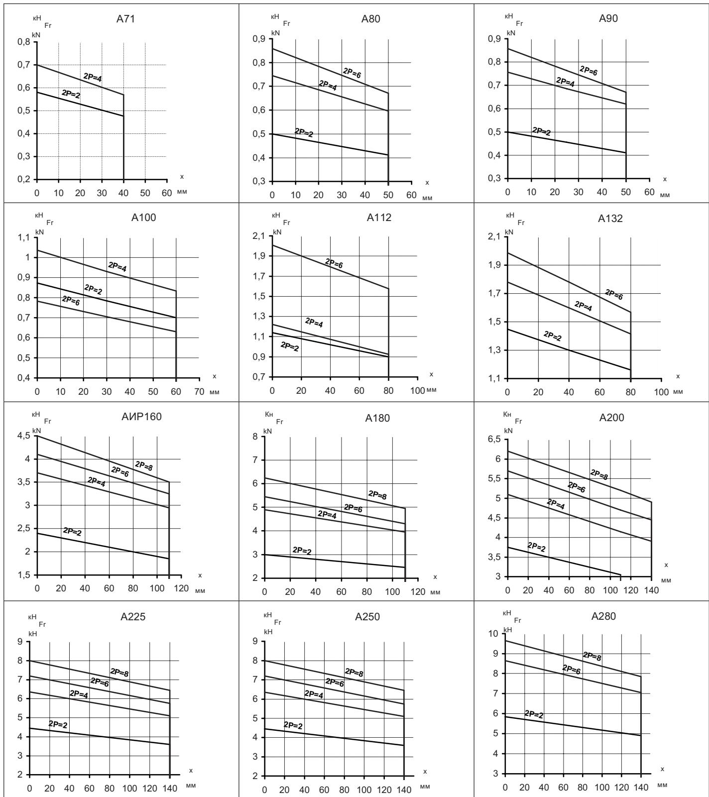
**Предельно-допустимая осевая нагрузка в зависимости от радиальной, приложенной в центре свободного конца вала  $F_a=f(F_r)$ . IM B3, B5, B14**
