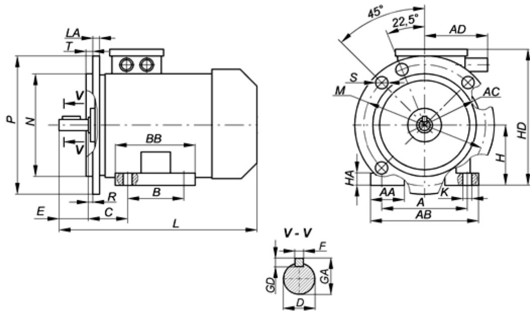
Рис. 8 - Двигатель монтажного исполнения IM2081, IM2001
