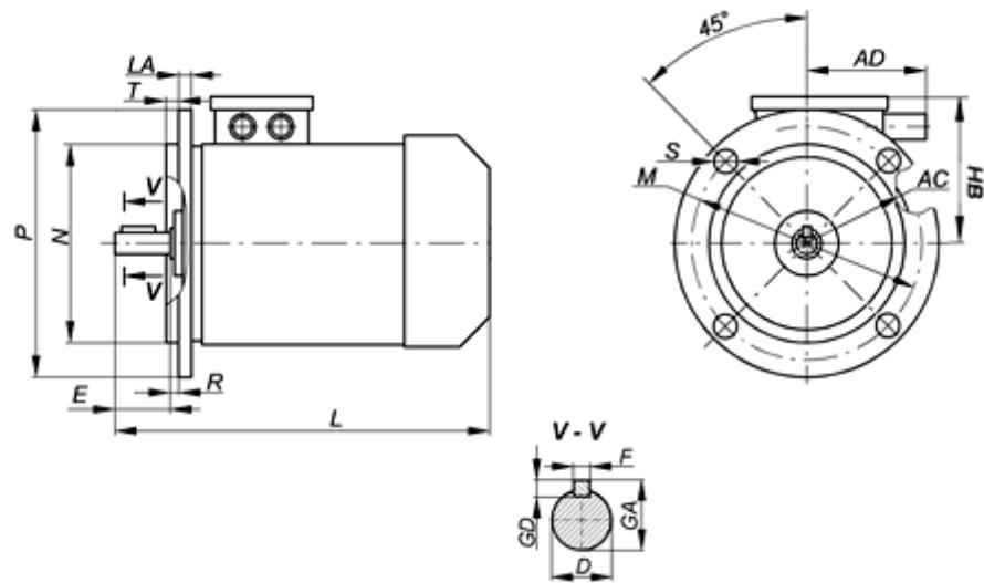
Рис.9 - Двигатель монтажного исполнения IM3081, IM3011, IM3031
