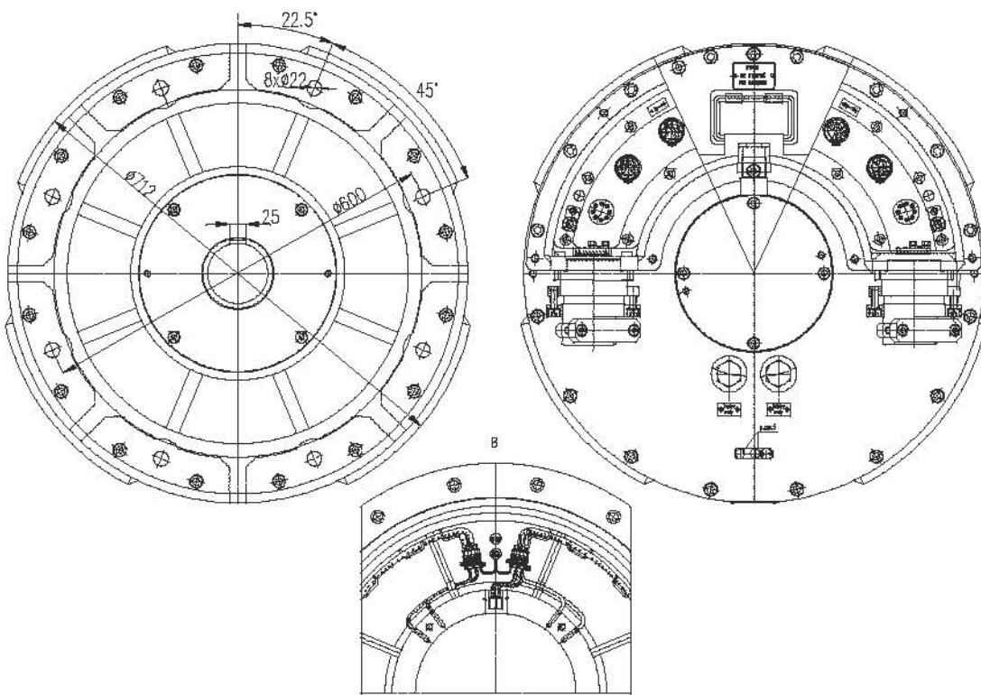
**РАЗМЕРНЫЙ РИСУНОК ДВИГАТЕЛЯ ТИПА dSKgwp 355L12/4 i dSKgwp 355H 12/4**
