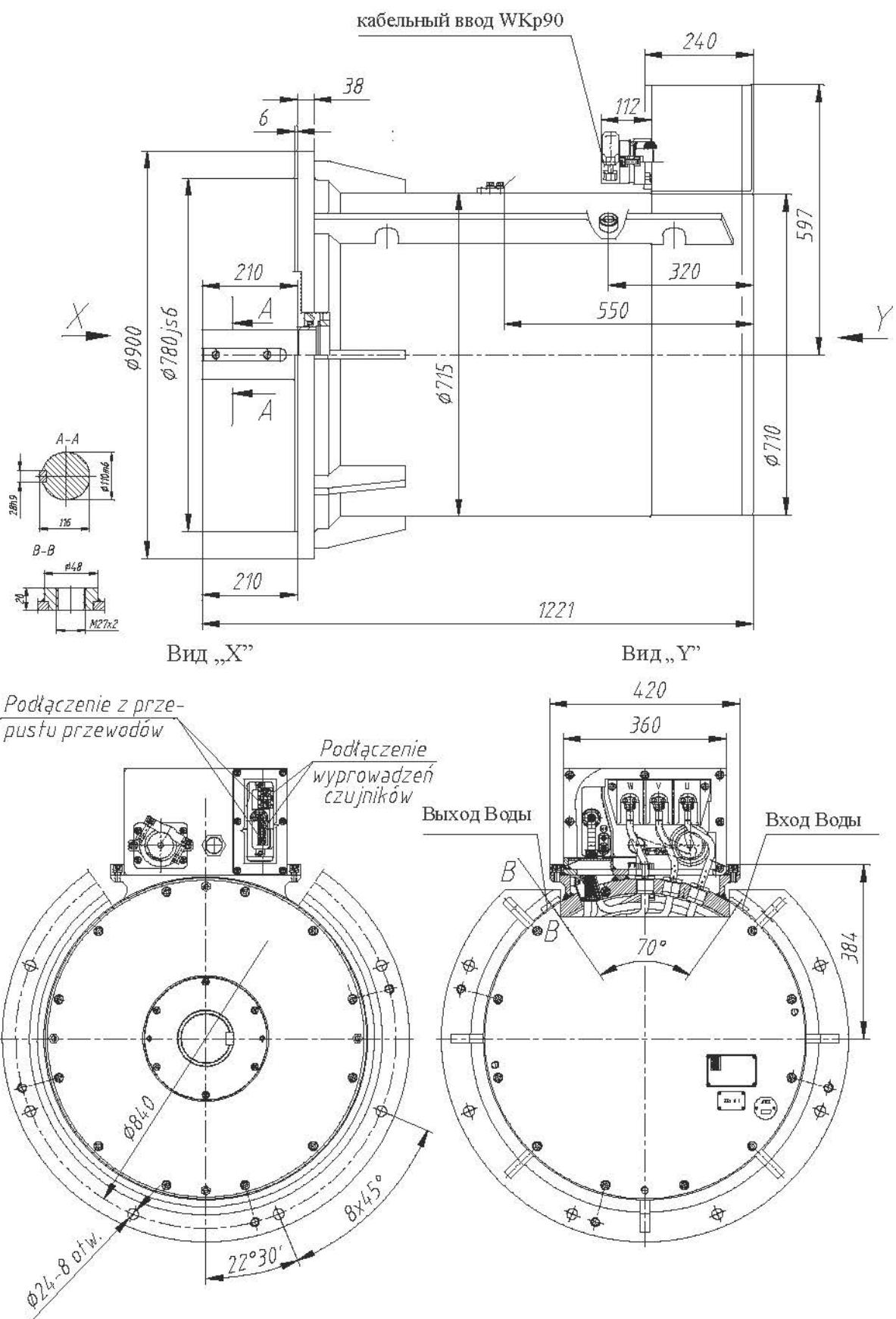
**РАЗМЕРНЫЙ РИСУНОК ДВИГАТЕЛЯ ТИПА dSKgwp 355M12/4**
