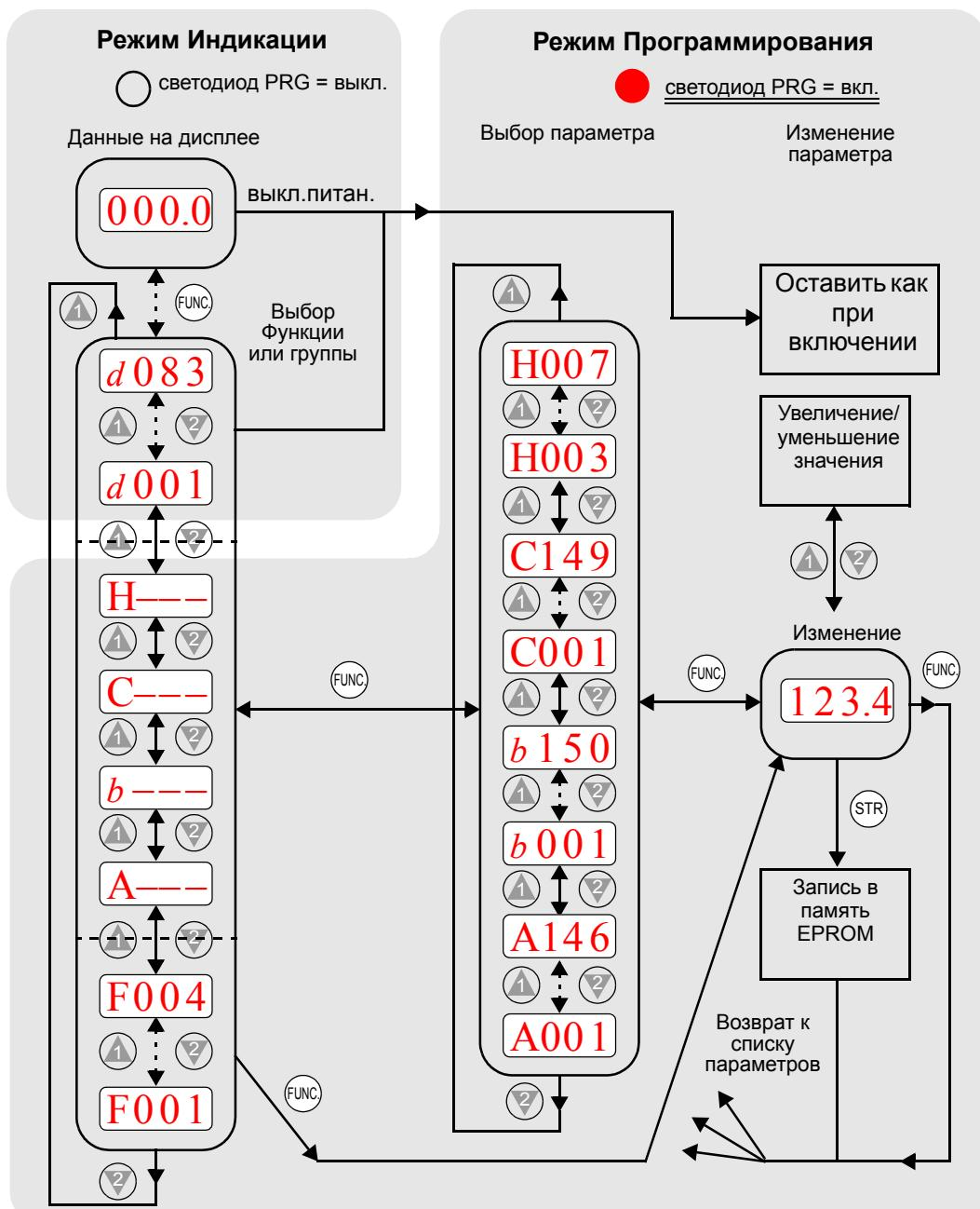
**ПРИМЕЧАНИЕ:** Дисплей пульта управления по 7 сегментов на цифру отображает буквы в нижнем регистре ("b" и "d"), что означает тоже, что и буквы в верхнем регистре ("B" и "D"), приведенные в этой инструкции.
