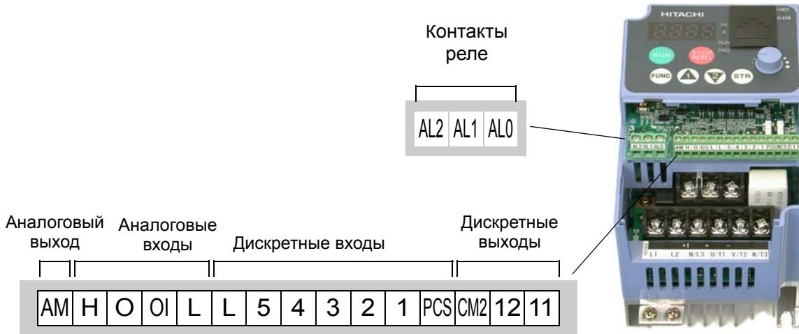
Спецификации клемм логических соединений приведены в следующей таблице:
