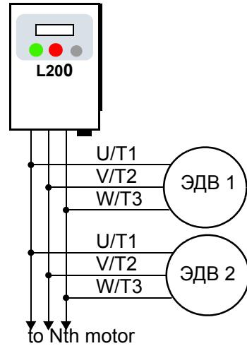
**ПРИМЕЧАНИЕ:** Скорости электродвигателей будут равны только теоретически. Это объясняется тем, что двигатели из-за разницы прилагаемой нагрузки, скольжение одного электродвигателя будет больше, даже если электродвигатели идентичны. Поэтому не используйте подобную технологию для многоосевых систем, в которых необходимо поддерживать точную разницу между положением осей.
