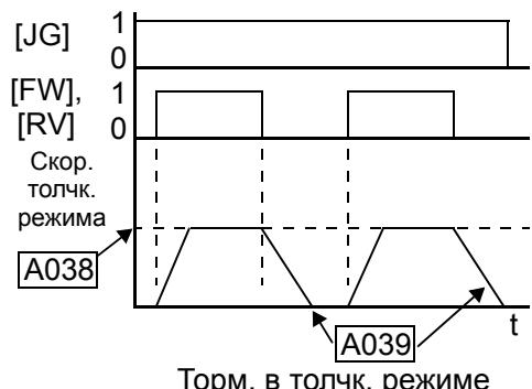
Когда клемма [JG] находится в состоянии ВКЛ. и подается команда Пуск, то инвертор выдает заданную выходную частоту на электродвигатель.
