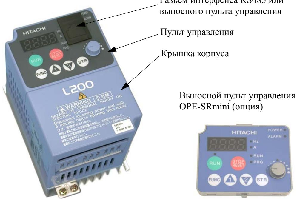
**Разъем интерфейса RS485.** Под защитной крышкой расположен разъем RJ45, предназначенный для подключения выносного пульта управления или для управления по интерфейсу RS485 MODBAS RTU.
