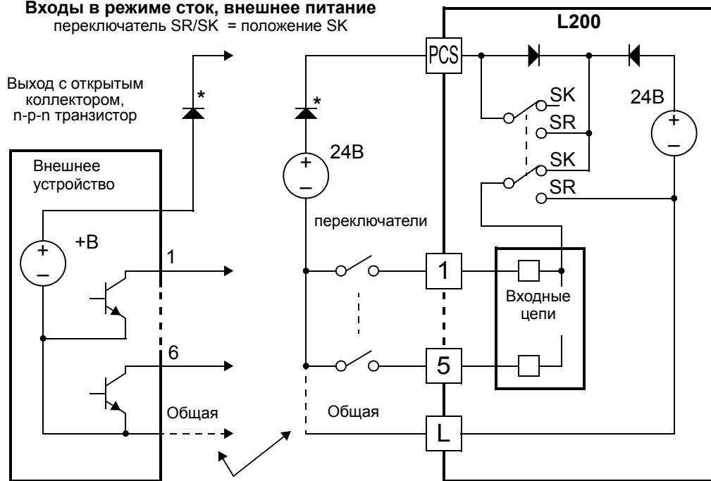
\* Примечание: Если общая клемма внешнего источника питания подключено к клемме [L], то установите диод.
