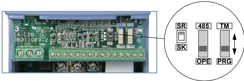
Изменив положение переключателя TM/PRG, можно перевести управление инвертора на входные клеммы. В приведенной ниже таблице показана зависимость управления инвертора от положения переключателя.
