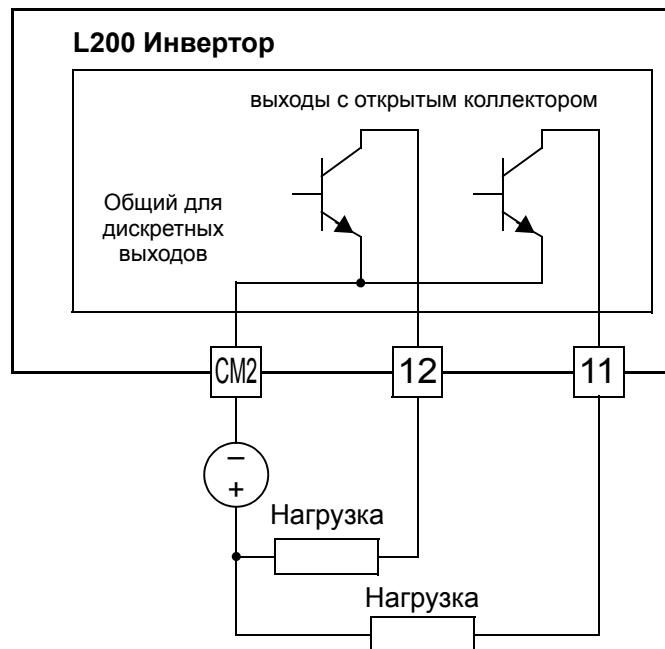
Если требуется выходной ток более 50 мА, то используйте выход инвертора для управления небольшим реле. Установите диод параллельно катушке, как указано, для подавления всплеска напряжения при выключении, или используйте бесконтактное реле.
