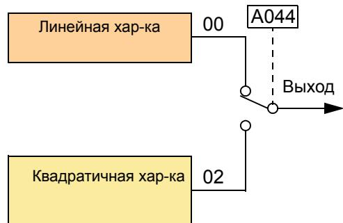
**Линейная и квадратичная характеристика** - Нижний левый график линейная характеристика от 0Гц до номинальной частоты A003. Напряжение остается постоянным при увеличении выходной частоты выше базовой. Правый нижний график квадратичная характеристика. На участке от 0Гц до номинальной частоты характеристика переменная..
