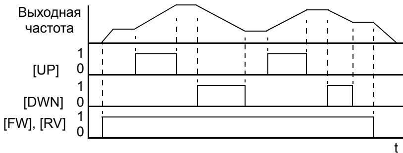
Инвертор позволяет сохранять значение частоты, установленное с помощью клемм [UP] и [DWN]. В параметре C101 можно включить или отключить режим сохранения. Если режим “Сохранения” отключен, то инвертор возвращается к значению частоты, которое использовалось до применения функции UP/DWN. Клемма [UDC] используется для сброса значения, сохраненного в памяти, и возврата к исходному значению выходной частоты.
