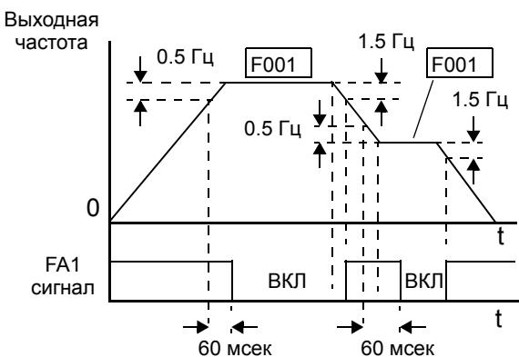
Функция достижения частоты [FA2] работает в том же режиме; в отличие от функции [FA1] для выходного сигнала используются два порога. Параметр C042 определяет порог включения клеммы во время разгона, а параметр C043 порог выключения во время торможения. Уровень сигнала - активный низкий (транзистор- открыт), время задержки - 60 мсек. Использование различных порогов для разгона и торможения приводит к несимметричности формы выходного сигнала. При необходимости, можно установить одинаковые пороги.
