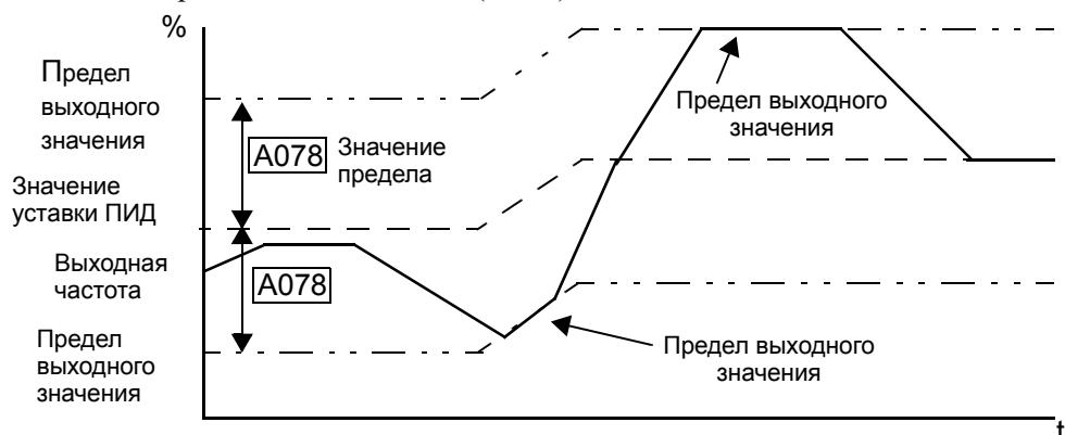
**Инвертирование функции ПИД регулятора (A077)** - В обычных системах отопления или вентиляции увеличение скорости вращения приводит к увеличению значения ОС. То есть вход ПИД регулятора = значение уставки - сигнал ОС. Для систем охлаждения воздуха, увеличение скорости вращения приводит к уменьшению сигнала ОС. Таким образом, вход ПИД регулятора = -(значение уставки - сигнал ОС). .
