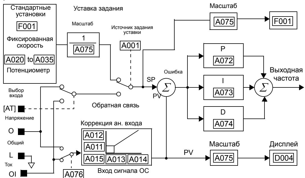
**Предел выходного значения ПИД регулятора (A078)** - Контроллер ПИД регулятора имеет встроенную функцию ограничения выходного значения. По этой функции измеряется разница между заданием уставки ПИД регулятора и значением выходной частоты инвертора, рассчитанные в процентном соотношении от полного диапазона каждого.
