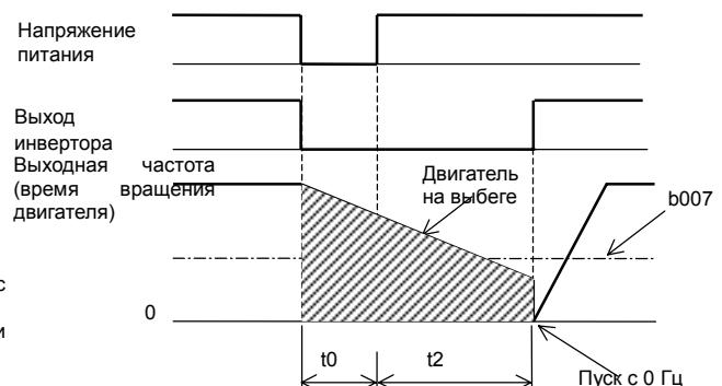
(2) Функция аварийного отключения из-за кратковременного пропадания или провала напряжения питания.
