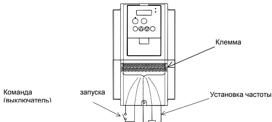
(2) Команда запуска и установка частоты производятся с цифрового пульта оператора.
