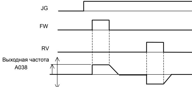
При работе в толчковом режиме характеристика разгона не настраивается, поэтому мы рекомендуем устанавливать значение толчковой частоты по возможности ниже, чтобы ограничить пусковой ток до минимума, иначе может произойти аварийное отключение, значение толчковой частоты устанавливается в А038.
