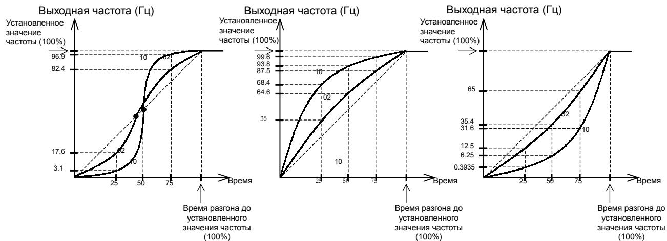
При помощи параметров A097/A098 выбирается общая форма кривой разгона/замедления, а коэффициентам нелинейности (A131/A132) задается соответствующая степень выпуклости. Если на одну из клемм программируемых входов установлена функция LAC (46: отмена функции LAD), то при замыкании клемм P24 и LAC инвертор выведет двигатель на заданное значение частоты.
