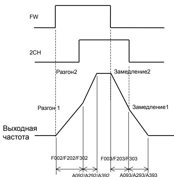
(Пример 2) В функции A094/A294 установлен код 01.
