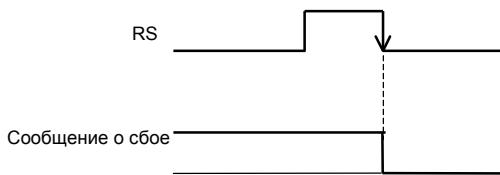
(Пример 3) Если в функции C103 установлен код 01 (синхронизация с вращающимся двигателем и вывод на рабочую частоту), то операция запуска двигателя может осуществляться подачей напряжения питания на вход инвертора.
