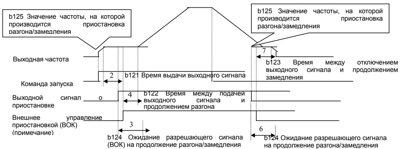
(Примечание) Сигнал подтверждения – это сигнал на продолжение разгона/замедления (BOK), присваивается на одну из клемм программируемых входов.
