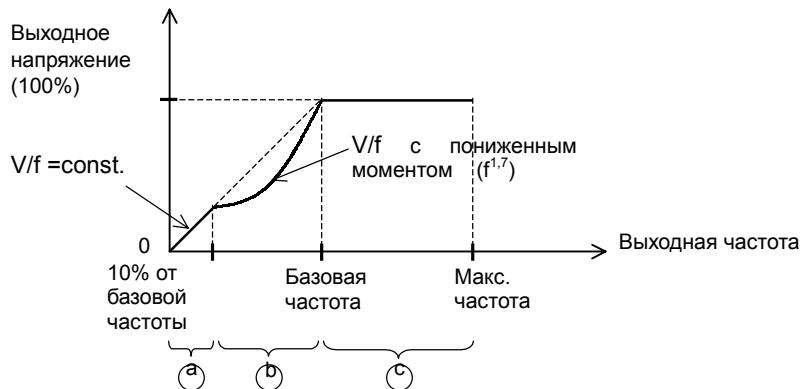
Отрезок ①: В диапазоне частот от нуля до 10% от базовой частоты V/f=const.
