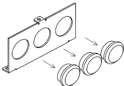
Примечание: Вынимать резиновые прокладки следует только в том случае, если Вы собираетесь использовать кабельный канал, так как из-за поврежденной изоляции может произойти короткое замыкание.
