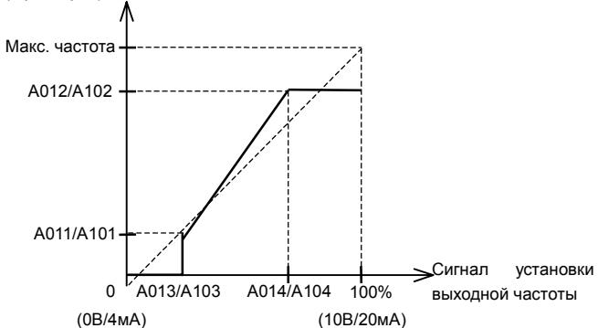
(2) Вариант установки выходной частоты с аналогового входа O2-L
