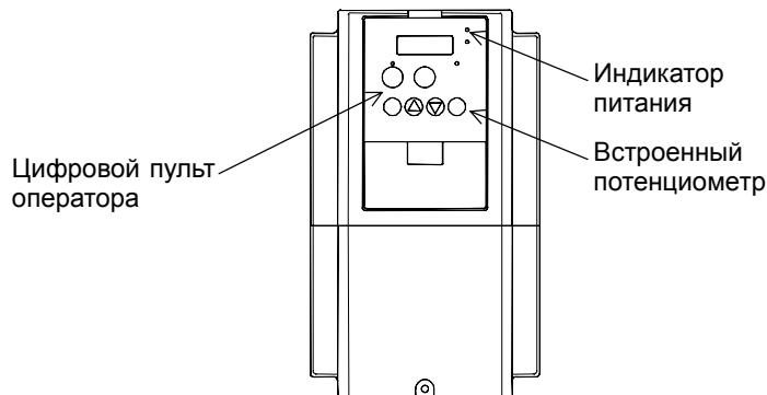
(3) Команда запуска и установка частоты производятся с цифрового пульта оператора и клеммами управления.
