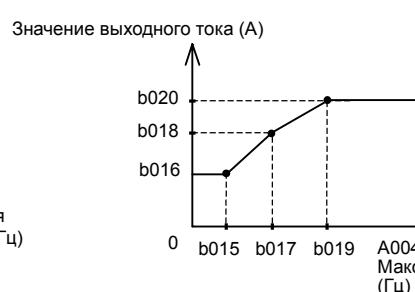
(Пример) b012=44(А), выходная частота=b017
