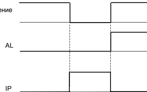
(3) Для сигнализации кратковременного пропадания или провала напряжения питания можно использовать программируемые выходы 11, 12 или выход реле сигнализации, установив на них функции IP(09) или (RNT: 11). Программирование выходных клемм 11-15 (C021-C025) и выхода реле сигнализации производится при помощи функции C021-C026.
