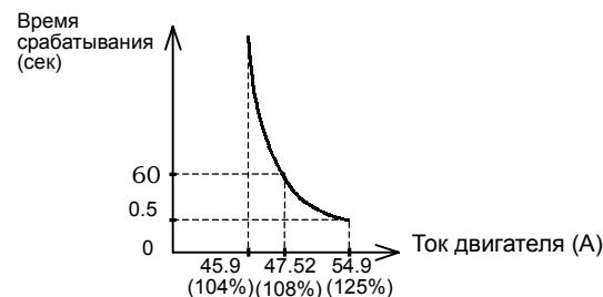
(3) Произвольно устанавливаемая характеристика электронной термозащиты двигателя
