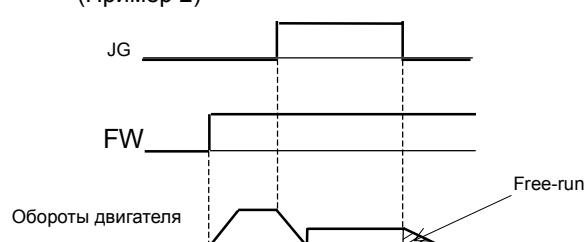
Если в А039 установлен один из кодов 00,01,02, то при подаче управляющего сигнала на клемму JG во время работы двигателя, толчковый режим не активизируется.
