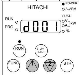
Чтобы вывести на дисплей режим просмотра нужно один раз нажать на клавишу FUNC, когда на дисплее высвечивается код необходимой функции просмотра
