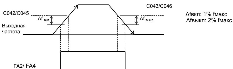
(3) Сигнал при работе на постоянной выходной частоте (06:FA3, 25: FA5)
