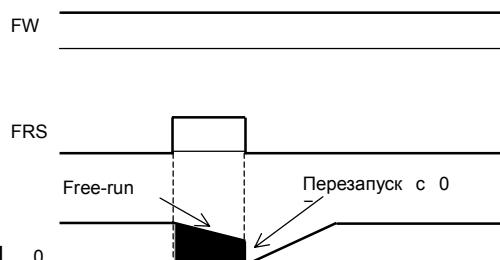
(Пример 2) Синхронизация с вращающимся двигателем и вывод на рабочую частоту по истечении времени, установленного в b003.
