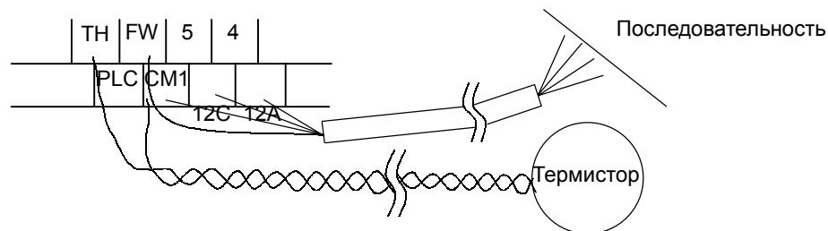
7. Если сигнал задания частоты включается и отключается при помощи контакта, используйте реле, которое обеспечит надежное срабатывание контактов даже при очень малых токах и напряжениях. (24В пост. тока, 3 мА)
