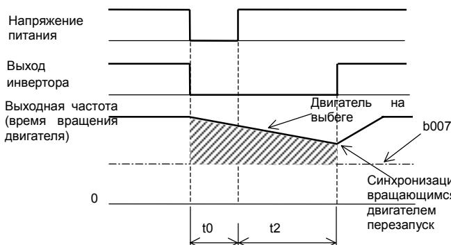
(пример 4) Выходная частота (время вращения двигателя) <b007
