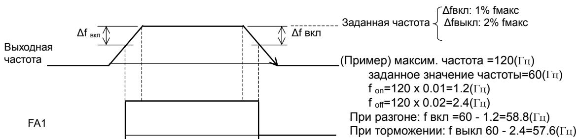
(2) Сигнал при работе в заданном диапазоне частот (02:FA2, 24: FA4)
