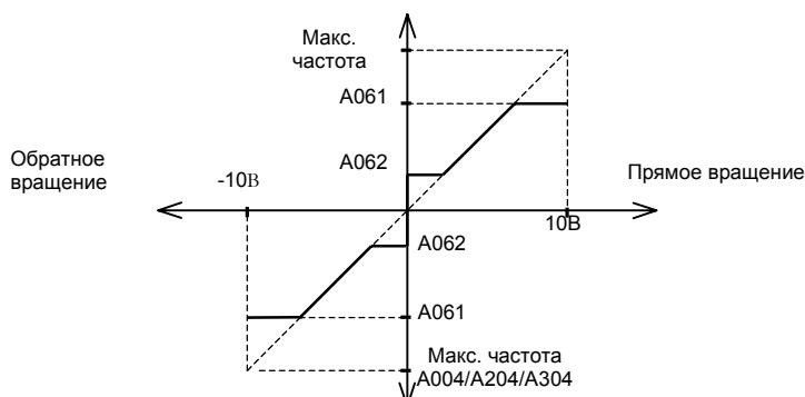
Если выходная частота задается аналоговым сигналом с входа O2, то при сигнале задания 0B значение частоты, установленное в A062, применяется к прямому и обратному вращению двигателя.
