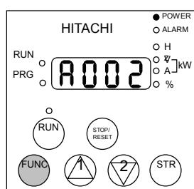
Изменение установленного значения подтверждается нажатием клавиши STR. Гаснет индикатор состояния клавиши RUN, таким образом функция запуска переводится на терминал. Можно установить другие коды функции.
