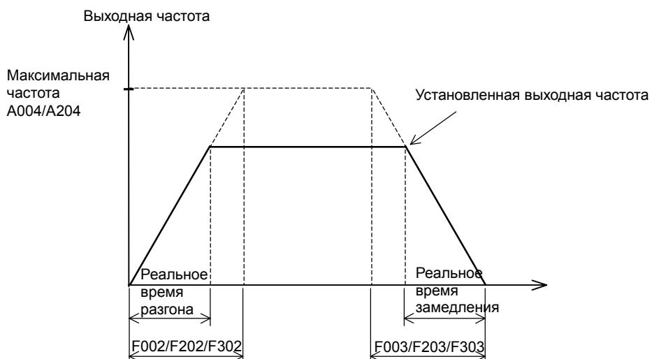
Какое бы малое время разгона/замедления Вы не устанавливали, оно не может быть меньше минимально допустимого времени разгона/замедления, характерного для той или иной механической системы. При расчете минимально допустимого времени разгона/замедления учитываются механические и инерционные характеристики применяемого оборудования.
