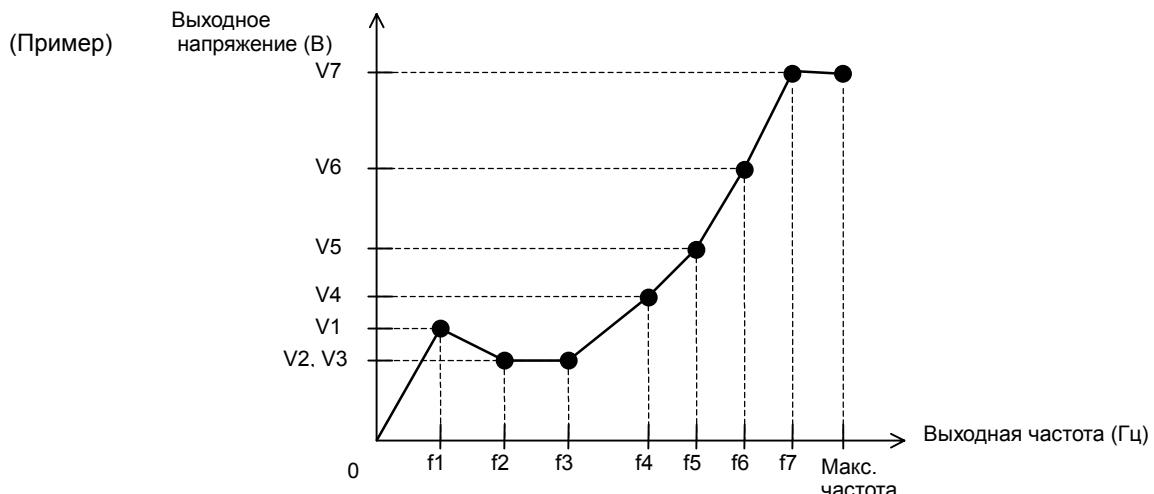
(Примечание) Даже если в одну из функций установки выходного напряжения для свободной вольт-частотной характеристики будет установлено 800 В, реальное выходное напряжение не превысит значения, установленного в функции b082 (номинальное напряжение двигателя).
