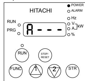
Из этого состояния можно осуществить переход в другие области расширения, а также в режимы установки основных функций и функций просмотра.
