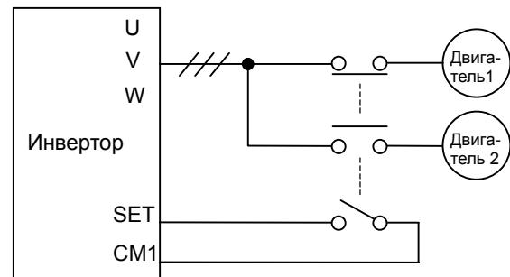
При работе, разница между применением функций установки параметров для 1-го/2-го или 3-го двигателя на дисплее не отображается. Поэтому, необходимо использовать функцию d005 (отображение состояния дискретных программируемых входов).
