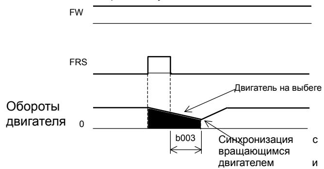
Перезапуск с 0 Гц производится независимо от скорости вращения двигателя. Время ожидания при этом не учитывается. Если выходная частота на момент отмены FRS имеет большее значение, то существует вероятность аварийного отключения из-за перегрузки по току.
