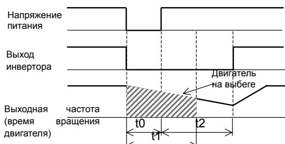
Т. к.  $t_0 < t_1$ , по истечении времени  $t_2$  производится перезапуск
