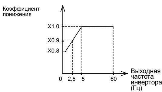
(Пример) b012 = 44(A), если выходная частота=2.5Гц.
