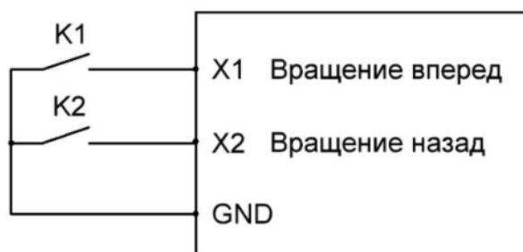
Рис. 5-11 Принципиальная схема двухпроводного режима работы
