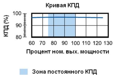
Рисунок 2 – Стандартная кривая КПД двигателей линии W22
