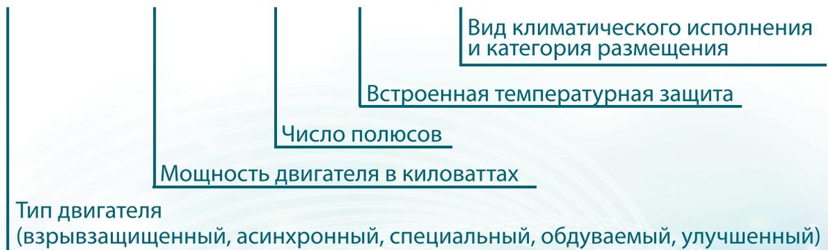
Пример записи обозначения двигателя ВАСОУ мощностью 13 кВт, синхронной частотой вращения 500 об/мин, со встроенной температурной защитой, вида климатического исполнения ХЛ1, исполнения по монтажу IM9633, с габаритно-присоединительными размерами по рисунку В.6 ТУ 3341-007-79682497-2010, исполнения по взрывозащите 1 Ex d IIB T4, напряжением 380 В, 50 Гц, при заказе и в документации другого изделия:
